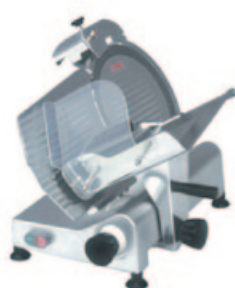
Nářezový stroj pro krájení základních uzenin a masa.
