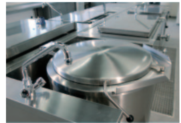
Kotel s míchadlem a přesnou regulací teplot, sklopný
